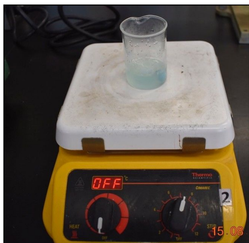
Fig. 5. Goma de mascar diluída en agua para medir conductividad y pH.
