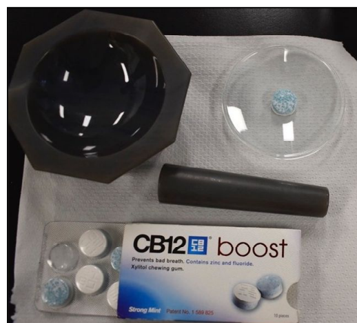
Fig. 4. Preparación de la goma de mascar para curva de calibración.
