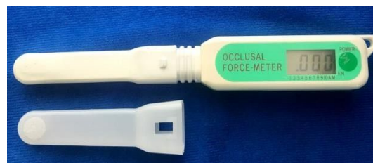
Imagen 1. Dispositivo hidráulico Occlusal Force Meter GM100 y cubierta plástica intercambiable. Fuente propia
