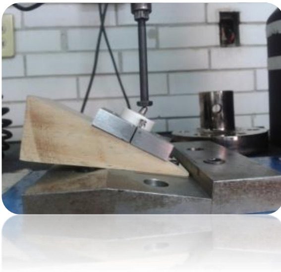
Figura 3. Aplicación de la carga con la máquina de pruebas mecánicas Instron
