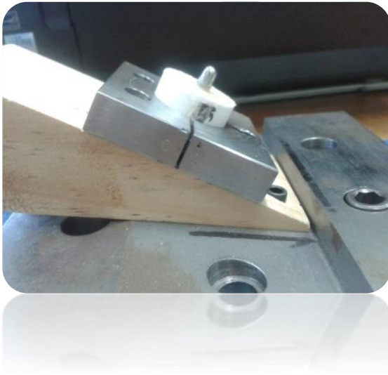
Figura 2. Muestra instalada en el aditamento angular
