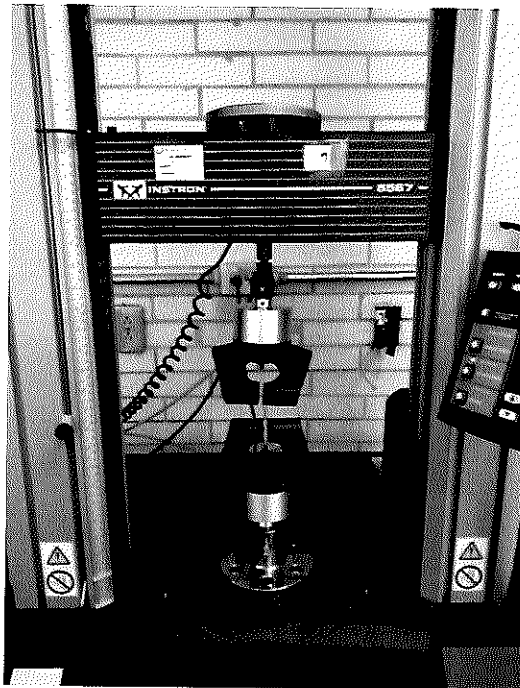
Figura 2. Vista frontal máquina universal de pruebas (Instron serie 5567, Bluehill 1, USA).
